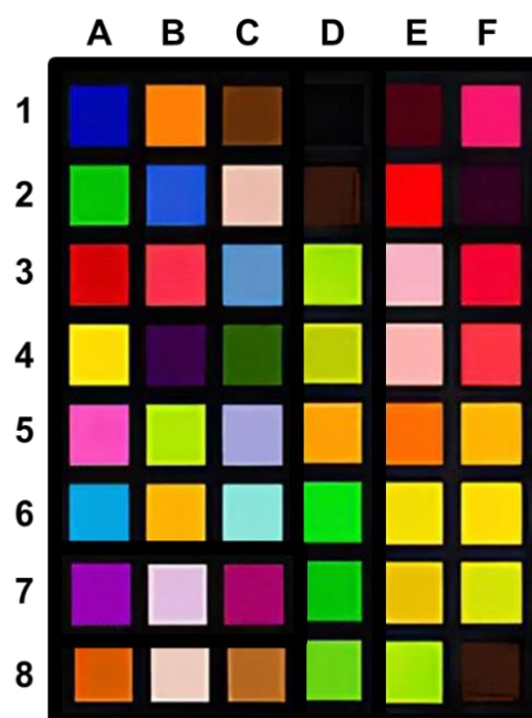
Figura 8: Verificador de cores utilizado para calibrar os valores de cores obtidos com scanner . Fonte: Adaptado ColorChecker, X-Rite, SG 140.
