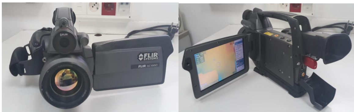
Figura 2. Câmera termográfica por infravermelho (Flir SC660, Flir Systems, USA).
